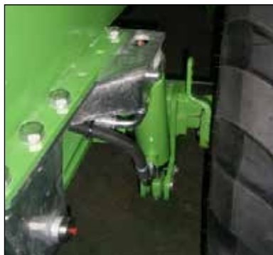
Verschraubtes Hydro-Tandem Fahrgestell
